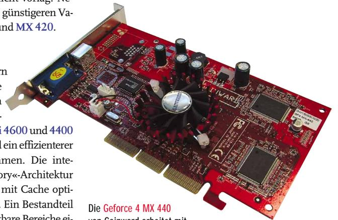
Die Geforce 4 MX 440 von Gainward arbeitet mit einer vom Hersteller garantierten höheren Taktfrequenz (290/432 MHz statt 270/400 MHz).
