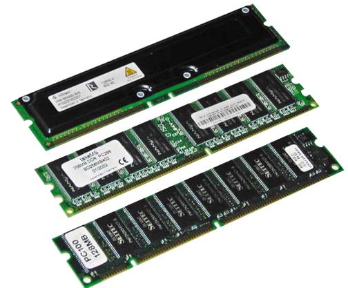
Von unten nach oben: SD-RAM, DDR-Speicher und ein Rambus-Modul für Intel-Prozessoren wie den P4.
