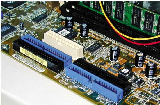
Boards wie das Asus A7V333 haben vier statt der üblichen zwei IDE-Kanäle. Dadurch lassen sich bis zu acht Laufwerke anschließen.
