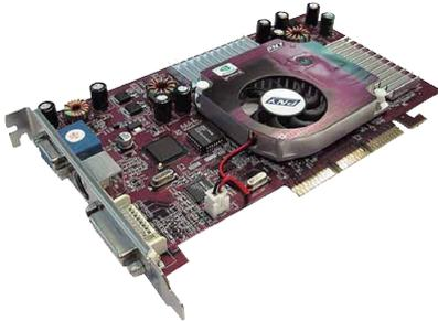
Die **Verto** gehört zur GeForce-4-Ti-4200-Serie mit 64 MByte DDR-RAM. Chip- und Speichertakt der Platine arbeiten mit 250/500 MHz und nutzen somit den von Nvidia vorgegebenen Standardtakt. Auch beim Kühler-Design hält sich PNY an die Empfehlungen des Chipherstellers. Die Frontblende kommt mit einem TV-Ausgang in S-Video-Form (ein Kabel liegt aber nicht bei) und einem DVI-Ausgang. Mit der Nview-Funktion des Detonator-Treibers können Sie somit einen zweiten Bildschirm anschließen.
