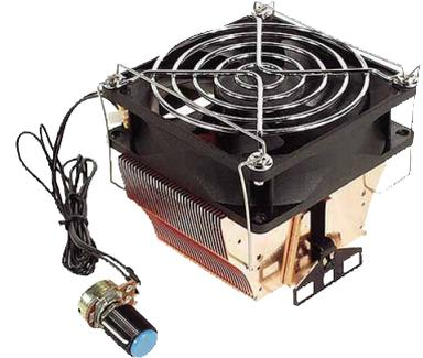
Der **SLK 800** soll den **AX7** als neuen Topkühler von Thermalright ablösen. Sechs Sockel-Nasen halten den 585 Gramm schweren Vollkopper-Brocken auf der Platine. Allerdings sitzt der Kühler durch die zu kleine Bodenplatte nur auf dem Die und verhindert, dass die CPU-Gumminoppen den Anpressdruck regulieren. Das kann die CPU im schlimmsten Fall bei der Montage zerstören.
