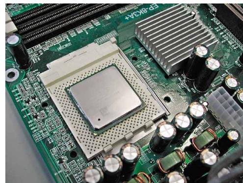
Alle Pentium-4-Prozessoren sind mechanisch und elektrisch inkompatibel zum Athlon-Sockel. Ein neues Mainboard ist also Pflicht.
