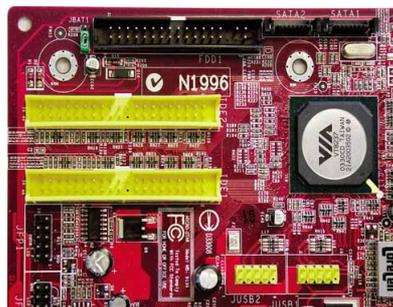
Alle aktuellen Platinen mit Serial-ATA-Anschlüssen bieten zusätzlich konventionelle IDE-Buchsen.
