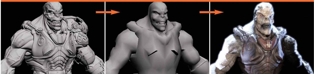
Links: Die Models der Unreal Engine 3 bestehen im Render-Programm aus bis zu **drei Millionen Polygonen**. Mitte: Eine spezielle Software rechnet das Modell auf **8.000 Dreiecke** herunter. Die so eingesparten Details lagern in einer
