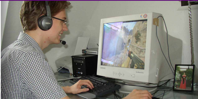
Nils Hesse an seinem Rechner. Spiele gewinnt er an einem P4 mit 2,6 GHz, zweimal 512 MByte RAM, einer ATI Radeon 9800 Pro und einer Standard-Soundkarte. Das steckt in einem Barebone-Gehäuse.
