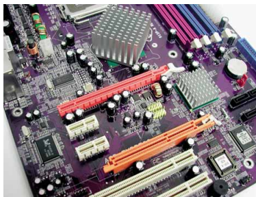
Eigenentwicklung: Elitgroup schaltet beim 915P-A zwei PCI-Slots zu einem AGP zusammen.
