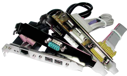
Gleich vier Slotbleche führen die Anschlussflut nach außen – viel Platz für Erweiterungskarten bleibt dann nicht mehr.
