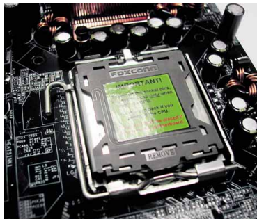
Asus schützt den empfindlichen Sockel 775 mit einer Plastikhaube vor Transportschäden.
