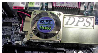
Gigabyte kühlt beim K8NSNXP-939 die Stromversorgung mit einem Lüfter – völlig überflüssig.
