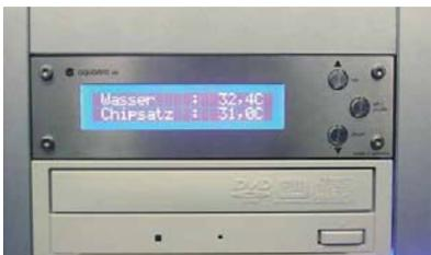
Das LCD zeigt Detailinfos über den Kühlkreislauf.
