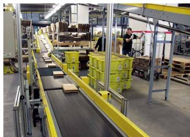
Insgesamt 42 Kilometer Fließband befördern Blizzards Werk verpackt zur Versandzentrale.
