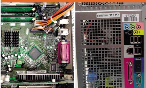
Von der Rückseite aus gesehen sitzt das Mainboard im BTX-Gehäuse auf der rechten Seite statt wie bei ATX auf der linken.
