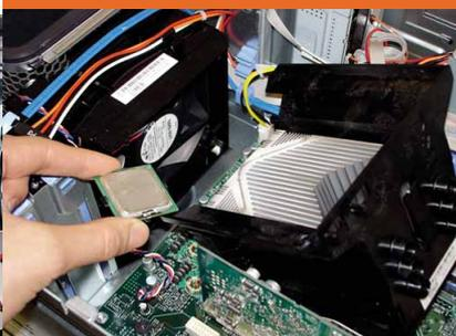
Eine ummantelte Kombination aus Lüfter und Kühlkörper bilden das riesige Thermalmodul auf der CPU.
