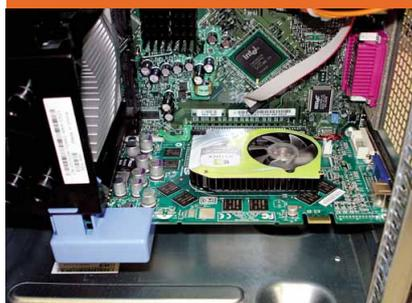
Die PCI-Express-Grafikkarte steckt bei BTX mit dem Lüfter nach oben im PC – optimal im Luftstrom.
