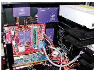
Extrem-Heatpipe: Das Zalman TNN-500AF kühlt CPUs bis 150 Watt komplett läuferlos.
