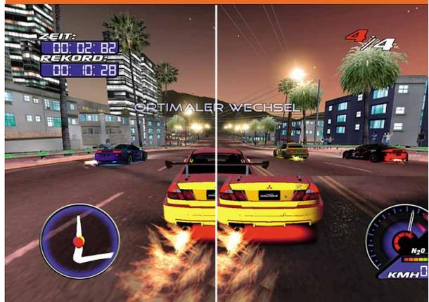
Stellt die 3D-Karte mehr fps dar als der Monitor, kommt es zu hässlichen Zeilenverschiebungen (rechts). Die Treiber-Option Vertical Sync (links) verhindert das. Um daraus resultierende Leistungsverluste zu vermeiden, aktivieren Sie bei mehr als 128 MByte Video-RAM Triple Buffering – sofern das Spiel dieses unterstützt.
