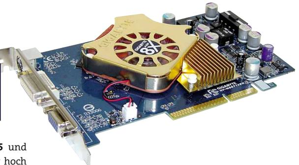
**A**nders als bei vielen Geforce-6600-GT-Karten mit AGP-Anschluss erhöht Gigabyte bei der **N66T128D** die Taktfrequenz des 128 MByte großen GDDR3-Speichers von 900 auf schnelle 1.000 MHz. Auch das verwendete Kühlsystem weicht vom Nvidia-Referenzdesign ab, ist aber angenehm leise und zuverlässig. Bei der Ausstattung gibt's nichts zu meckern: Das etwas angegraute **Spellforce** (GameStar-Wertung: 85) fesselt immer noch für Stunden an
