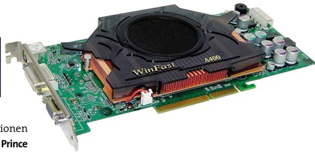
**A**uf der **Winfast A400 TDH** von Leadtek schuftet eine Geforce-6800-GPU mit zwölf Pixel-Pipelines, fünf Vertex Shadern und voller 256-Bit-Speicher-Anbindung. Allerdings verschwenden die DDR1-Bausteine mit lahmern 2,9 ns Zugriffszeit viel Leistungspotenzial. Immerhin schafft der starke Kupferkühler etwas Spielraum, um den Grafichip per mitgeliefertem Tuning-Tool zu übertakten. Der Ventilator rotiert deutlich hörbar, wenn auch nicht nervig.
