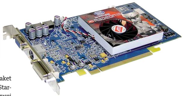
**S**apphires **Radeon X800 Hybrid** bringt Oberklasse-Features in bezahlbare Regionen: 256 MByte GDDR3-Arbeitspeicher mit 2,0 ns schneller Zugriffszeit und einer dicken 256-Bit-Anbindung bietet keine andere Karte im Testfeld. Allerdings rechnet die **X800 Hybrid** nur mit einem Chip- und DDR-Speichertakt von 390/700 MHz. Dafür arbeitet der kleine, temperaturgeregelte, Lüfter im Desktop-Betrieb angenehm leise. Erst bei voller 3D-Belastung rotiert er hörbar,
