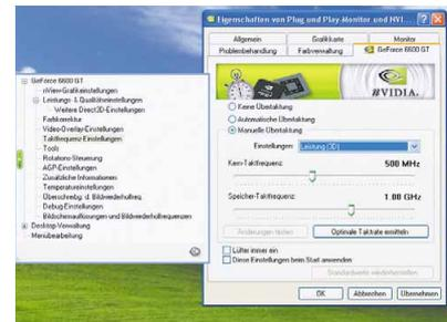
Im Forceware-Treiber versteckt Nvidia nützliche Extra-Features. Mit der Datei »Coolbits.reg« von CD/DVD schalten Sie die praktischen Helfer wie zum Beispiel die Übertaktungsfunktion frei. Klicken Sie dazu doppelt auf die Datei und bestätigen Sie die Änderung an der Registrierungsdatenbank von Windows mit »Ja«. Wie Sie Ihre Karte nun zu mehr MHz bringen, lesen Sie im Artikel »Geforce-Karten übertakten«. FK
