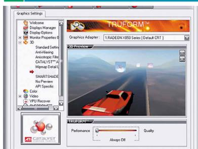
Das nur von Radeons eingesetzte »Trueform« verschönert gekrümmte Oberflächen, indem es einfach die Polygonzahl von 3D-Objekten erhöht. Eine Spielfigur wirkt
