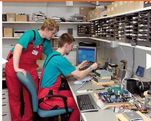
Bevor ein Rechner in die Produktion geht, werden die Komponenten auf Kompatibilität und Stabilität geprüft.
