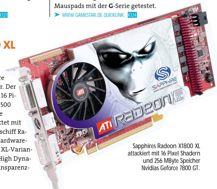
Sapphires Radeon X1800 XL attackiert mit 16 Pixel Shadern und 256 MByte Speicher Nvidias GeForce 7800 GT.
