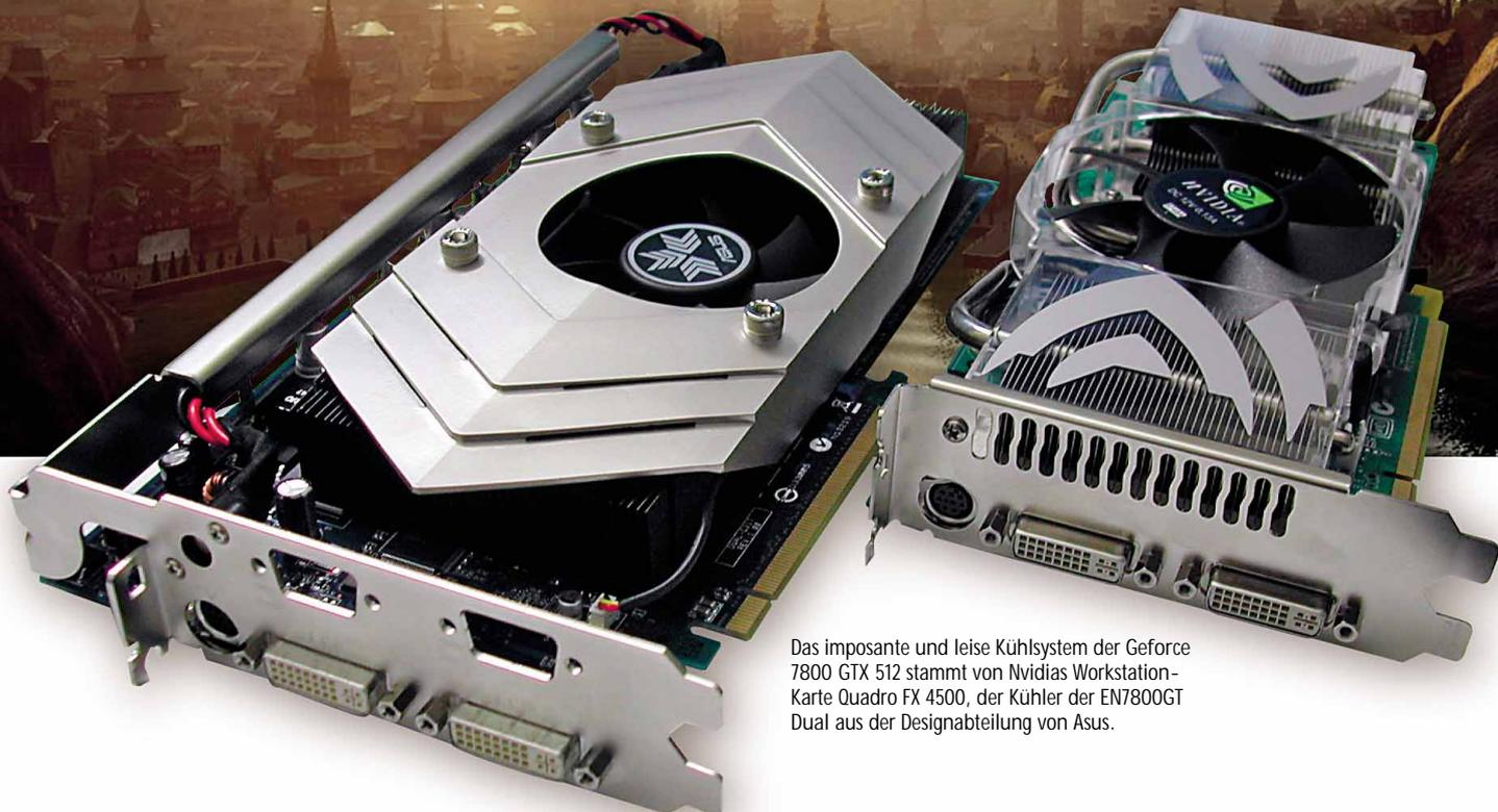
Das imposante und leise Kühlsystem der Geforce 7800 GTX 512 stammt von Nvidias Workstation-Karte Quadro FX 4500, der Kühler der EN7800GT Dual aus der Designabteilung von Asus.
