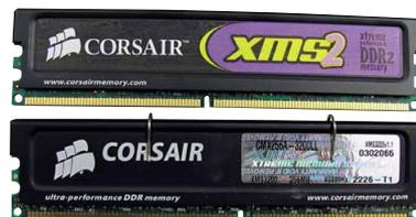
Der DDR2-Riegel (oben) hat eine andere Einkerbung als ein DDR1-Modul (unten).
