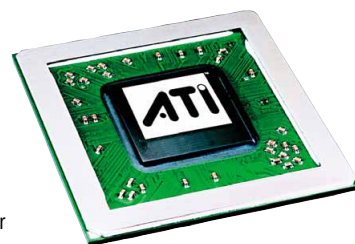
Der R580-Grafikprozessor einer Radeon X1900 hat 16 Textureinheiten, aber dreimal so viele Pixel Shader.
