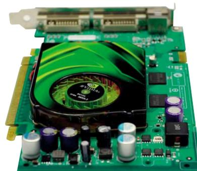
Die kompakte Geforce 7600 GT kommt ohne zusätzlichen Stromanschluss aus.
