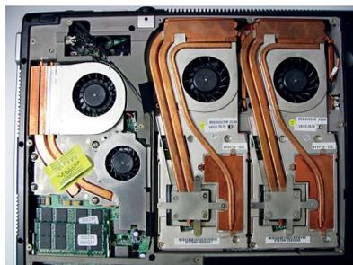
Heatpipe-Konstruktionen führen die gewaltige Hitze von **SLI-Gespann** und Prozessor ab.
