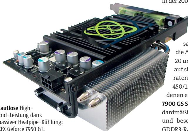
Lautlose High-End-Leistung dank passiver Heatpipe-Kühlung: XFX Geforce 7950 GT.
