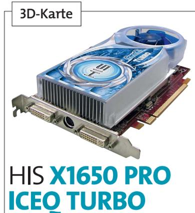
**D**ie riesige Zwei-Slot-Kühlkonstruktion der **Radeon X1650 PRO IceQ Turbo** von HIS wirkt für eine Mittelklassekarte überdimensioniert, kühlt aber flüsterleise. Ruhe herrscht auch im Karton: Neben den normalen Kabeln und DVI-Adaptoren finden Sie lediglich das bereits vier Jahre alte **Dungeon Siege** (GameStar-Wertung: 75). Dank HDCP-Chip auf der Platine werden immerhin zukünftige HD-Filme unterstützt; zusätzlich ist ein TV-Out mit an Bord.
