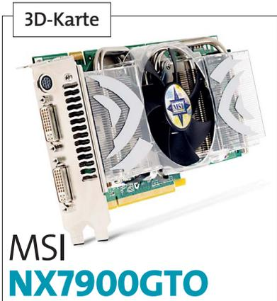
**S**parfüchse aufgepasst: Unter dem Decknamen **NX7900GTO** verkauft MSI eine beinahe vollwertige Geforce 7900 GTX für extrem günstige 250 Euro – eine »echte« GTX kostet immerhin knapp 400 Euro. Auf beiden Karten werkelt ein G71-Grafikchip mit 24 Pixel- und acht Vertex-Shadern sowie 650 Megahertz Takt. Auch der GDDR3-Arbeitsspeicher ist auf beiden Karten mit 512 MByte gleich groß, taktet bei der GTO allerdings nur mit 1.320 MHz statt mit 1.600 MHz.
