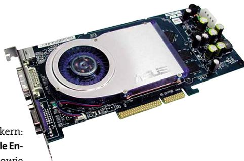
**U**m die **V9999GT** für preiswerte 320 Euro anzubieten, musste Asus zweimal in die Trickkiste greifen. Statt wie bei normalen Geforce 6800 GTs mit 256 MByte Speicher moderne GDDR3-Chips zu verwenden, setzt Asus auf günstigere 128 MByte DDR1-RAM. Außerdem takteten GPU und DDR-Speicher nicht mit den üblichen 350 / 1.000 MHz sondern nur mit 350 / 700 MHz. Die Kühlung übernimmt ein leistungsfähiger, aber deutlich hörbarer Kühler. Bei der
