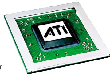
Der R580-Grafikprozessor einer Radeon X1900 hat 16 Textureinheiten, aber dreimal so viele Pixel Shader.
