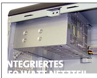
**INTEGRIERTES 50 WATT NETZTEIL**
