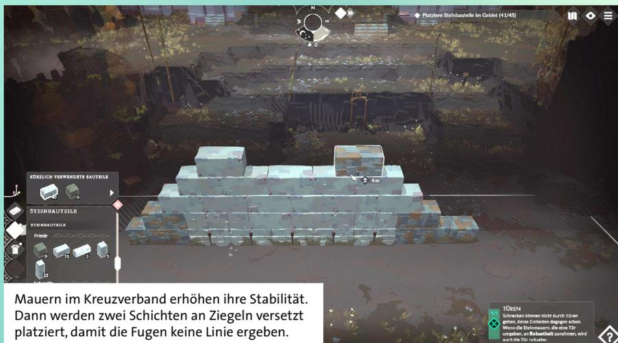
Mauern im Kreuzverband erhöhen ihre Stabilität. Dann werden zwei Schichten an Ziegeln versetzt platziert, damit die Fugen keine Linie ergeben.
