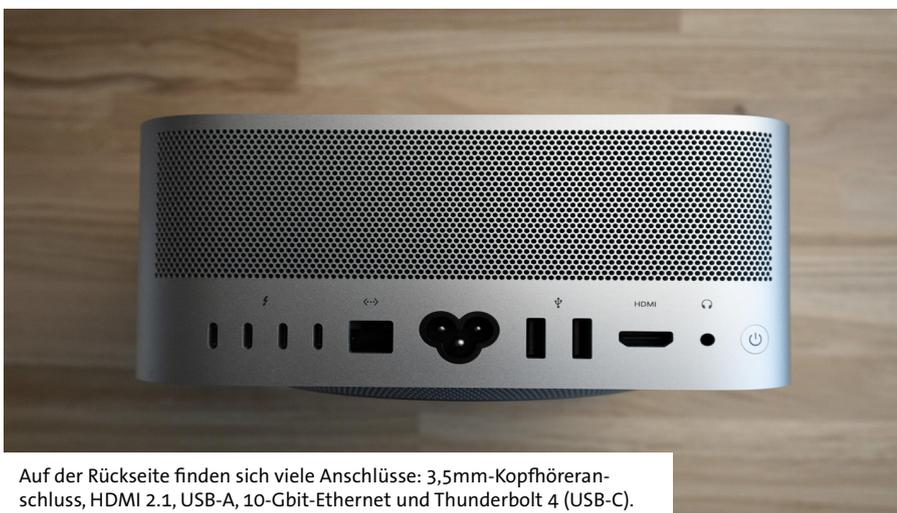
Auf der Rückseite finden sich viele Anschlüsse: 3,5mm-Kopfhöreranschluss, HDMI 2.1, USB-A, 10-Gbit-Ethernet und Thunderbolt 4 (USB-C).
