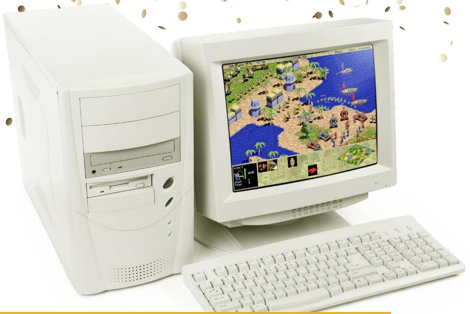
Ein typischer PC von 1997: schmucklos graues Tower-Gehäuse mit ein paar angedeuteten Rundungen, farblich unpassendes CD-Laufwerk und Floppy; dazu eine graue Tastatur vor einem ebenso grauen Röhrenbildschirm. Nichts davon gibt es im Gaming-Design oder gar mit Beleuchtung, die Hersteller differenzieren noch nicht zwischen Büro- und Spiele-PCs.
