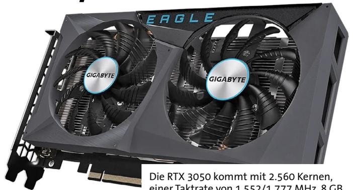
Die RTX 3050 kommt mit 2.560 Kernen, einer Taktrate von 1.552/1.777 MHz, 8 GB GDDR6 (14 Gbps) und 130 Watt TDP.
