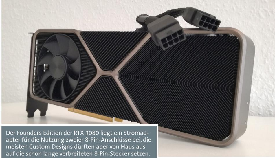
Der Founders Edition der RTX 3080 liegt ein Stromadapter für die Nutzung zweier 8-Pin-Anschlüsse bei, die meisten Custom Designs dürften aber von Haus aus auf die schon lange verbreiteten 8-Pin-Stecker setzen.
