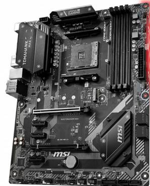
Das Mainboard MSI B450 Tomahawk Max unterstützt für Ryzen-3000-CPU's wie den links zu sehenden Ryzen 5 3600 Speichertaktraten von bis zu 4.133 MHz – offiziell zählt aber alles oberhalb von 3.200 MHz als Overclocking.
