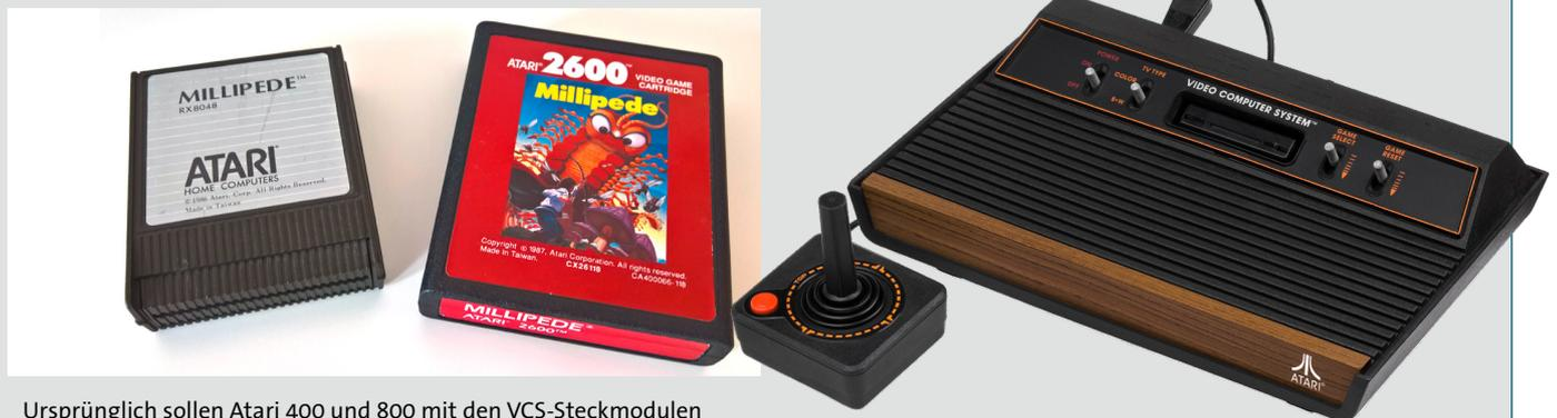
Ursprünglich sollen Atari 400 und 800 mit den VCS-Steckmodulen kompatibel sein, der Plan wird jedoch wieder verworfen und die Computer bekommen eigene, deutlich kleinere Module, zusätzlich zu Kassetten und Disketten. 1982 kommt noch ein drittes Atari-Modulformat hinzu: für die Konsole 5200. Es ist ebenfalls nicht kompatibel.
