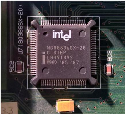
Der Prozessor des Test-PCs ist 2x2 Zentimeter klein – und läuft so nackt, wie er sich auf dem Bild präsentiert: ohne Kühlkörper, ohne Lüfter, bedeckt nur mit Staub.
