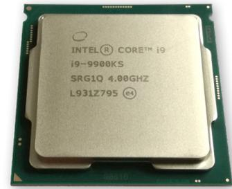
Der Core i9 9900KS passt als Coffee-Lake-Refresh-CPU wie der Core i9 9900K auf den Sockel 1151 v2 und entsprechende Mainboards mit 300er-Chipsatz.
