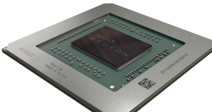
Der Navi-10-Grafikchip der Radeon RX 5700 (XT) ist durch die 7-Nanometer-Fertigung deutlich kompakter und daher preiswerter zu fertigen als die Vega-GPUs.
