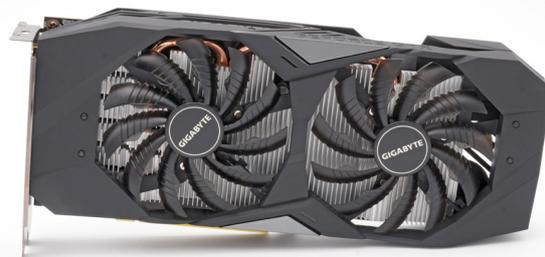
Das Topmodell von Gigabyte hört auf den Namen Geforce GTX 1650 Gaming OC 4G und ist ein zwei Slot hohes, ab Werk übertaktetes Custom Design.
