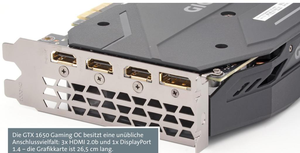
Die GTX 1650 Gaming OC besitzt eine unübliche Anschlussvielfalt: 3x HDMI 2.0b und 1x DisplayPort 1.4 – die Grafikkarte ist 26,5 cm lang.
