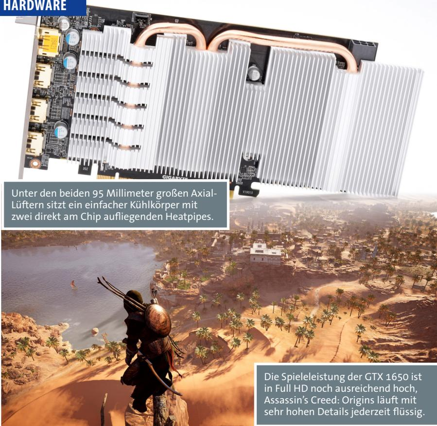
Unter den beiden 95 Millimeter großen Axial-Lüftern sitzt ein einfacher Kühlkörper mit zwei direkt am Chip aufliegenden Heatpipes.
