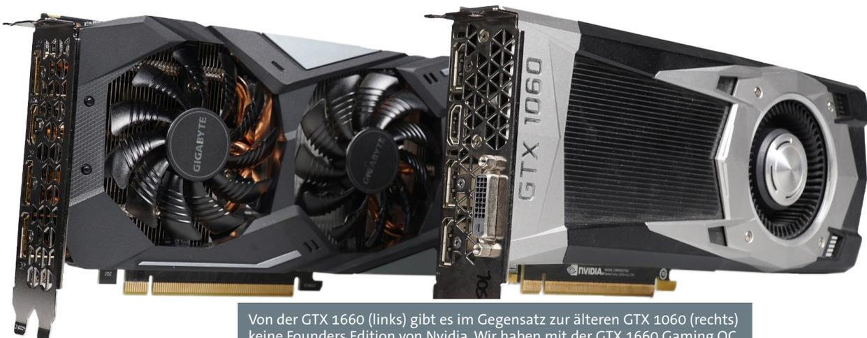
Von der GTX 1660 (links) gibt es im Gegensatz zur älteren GTX 1060 (rechts) keine Founders Edition von Nvidia. Wir haben mit der GTX 1660 Gaming OC 6G von Gigabyte ein übertaktetes Custom Design getestet.
