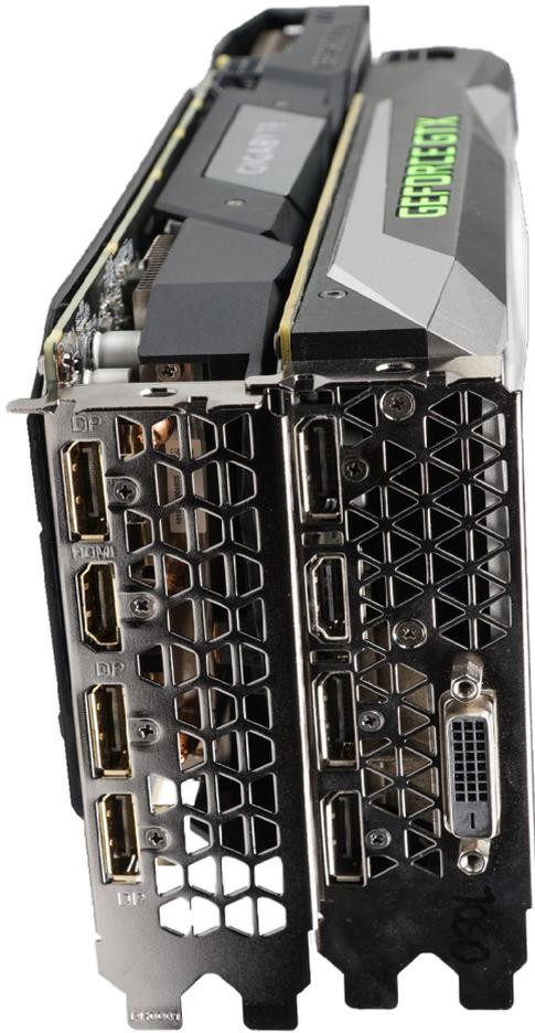
Die vorhandenen Anschlüsse können je nach Modell variieren. Der bei der GTX 1060 rechts noch verbaute DVI-Anschluss gerät heute mehr und mehr aus der Mode.
