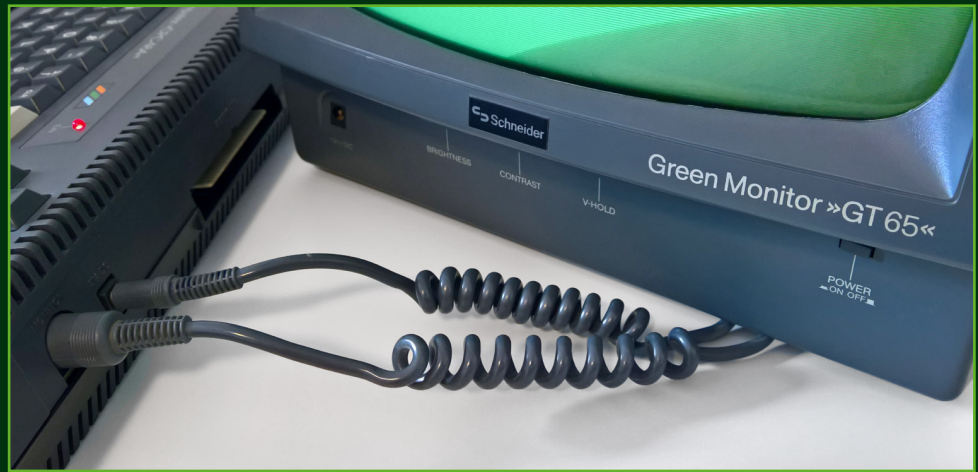
Zwei Kabel verbinden den CPC mit dem Monitor, der nicht nur das Bildsignal annimmt, sondern auch im Gegenzug Strom liefert. Das ist praktisch – obwohl die Kabel arg kurz geraten sind.
