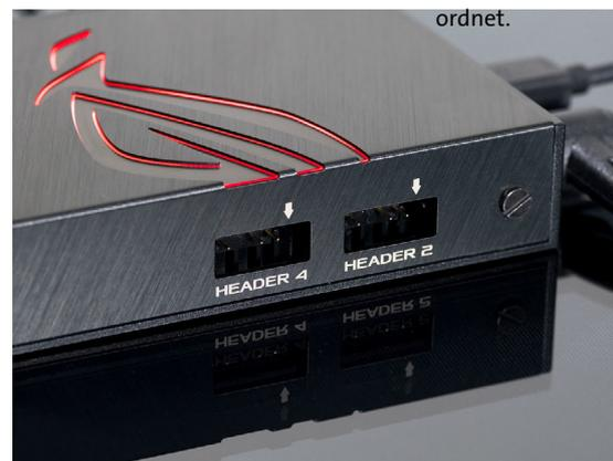
An den insgesamt vier Anschlüssen des Aura Terminals lassen sich adressierbare LED-Streifen anschließen.
