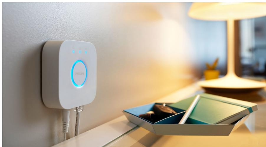
Die Bridge ist die Grundvoraussetzung, um die Philips-Hue-Lampen verwenden zu können.
