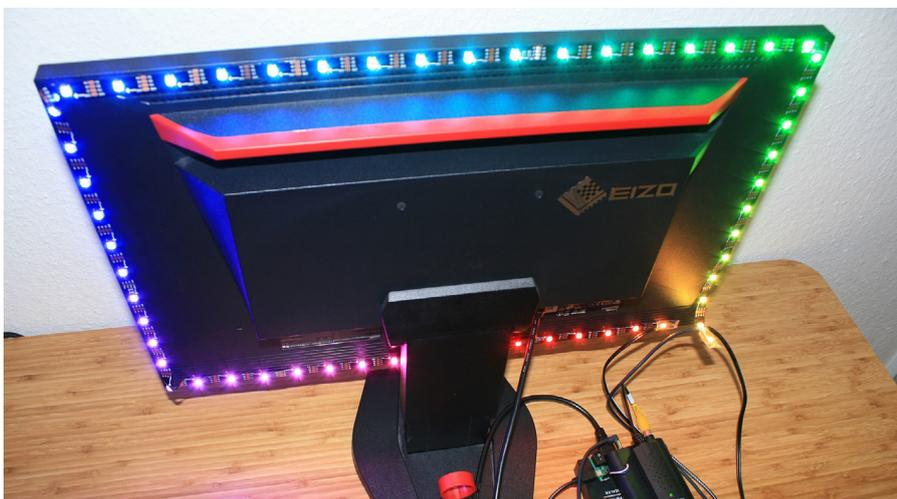
Die LED-Streifen des Insanelight werden auf die Abmessungen des Monitors zugeschnitten.
