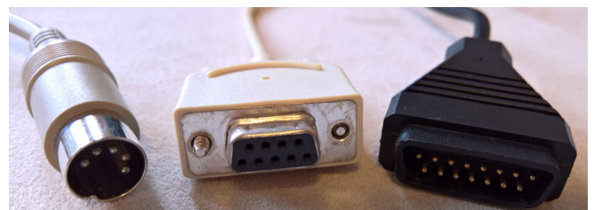
Anschlussvielfalt von 1993: DIN-Stecker für die Tastatur, serieller Anschluss für die Maus, Gameport-Stecker für Joystick und Gamepad. Nicht im Bild sind die beiden ebenfalls aktuellen PS/2-Anschlüsse für Mäuse und Tastaturen. Heute ist all das durch USB ersetzt.
