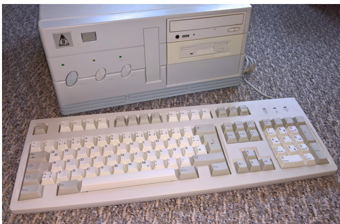
Ein zeitgenössischer Desktop-PC mit 20 MHz schneller 386-CPU, VGA-Grafikkarte, 4 MB RAM sowie 80-MB-Festplatte. Und Turbo-Taste.
