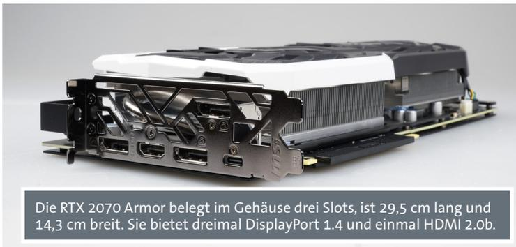
Die RTX 2070 Armor belegt im Gehäuse drei Slots, ist 29,5 cm lang und 14,3 cm breit. Sie bietet dreimal DisplayPort 1.4 und einmal HDMI 2.0b.
