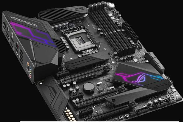
Für den Test des Core i9 9900K nutzen wir das Asus-Mainboard XI Hero Wi-Fi mit Z390-Chipsatz. Die CPU ist aber grundsätzlich auch auf Platinen mit anderen 300er-Chipsätzen von Intel lauffähig.
