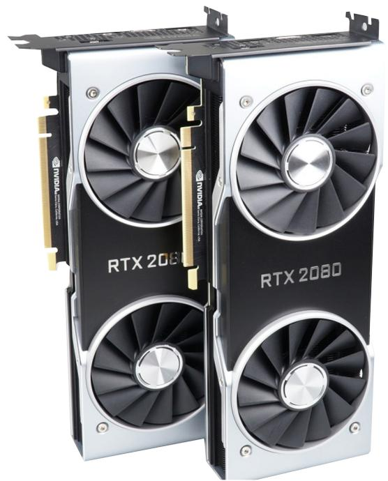
Grafikkarten-Zwillinge: Die RTX 2080 Ti und die RTX 2080 von Nvidia sind als Founders Edition gleich lang und breit sowie optisch abgesehen vom Schriftzug und den Stromanschlüssen (2080 Ti: zwei Mal x 8-Pol, 2080: ein Mal 8-Pol, ein Mal 6-Pol) identisch.
