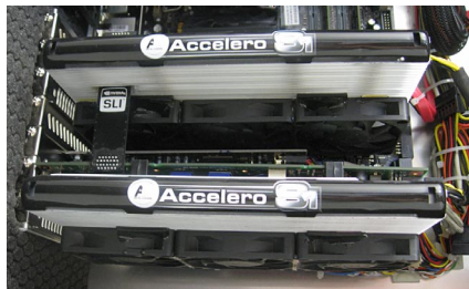
Pro Geforce 8800 GT kümmern sich drei Flüsterlüfter und unzählige Alu-Lamellen von Artic Cooling um die Kühlung.
