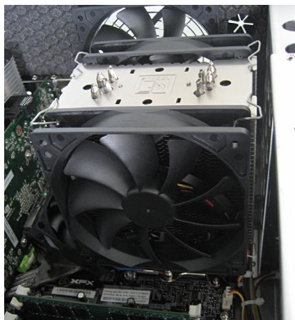
Den um fast 900 MHz übertakteten Prozessor kühlen zwei 120-mm-Lüfter und ein massiver Aluminiumblock.
